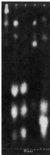
Fig. 12. Beispiel: Photokopie eines Papierchromatogramms Fraktionen aus Bufo formosus , System Benzol-Chloroform-(7:5)/ Formamid. Bei Gemischen wurden ca. 0,2 mg, bei reinen Stoffen ca. 0,02 mg aufgetragen. Spalt 1,5 mm. Einstellung auf 302,1 \mu , Belich- tungszeit 8 Sek.
