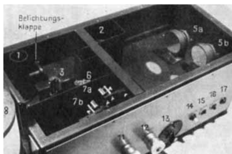
Fig. 2. Kopiergerät, Ansicht geöffnet Sichtbar sind: Gehäuse der Lampe (1) mit Belichtungs- klappe, Spiegel (2) (3) (5a) (5b) (7a) (7b) und LITROW-Halbprisma (6).
